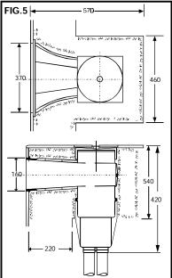
2.- SKIMMER SV: Cubra la boca del skimmer para proteger su interior y las perforaciones de la cara frontal durante la construcción. Posicione el skimmer y estructure con fierro y
