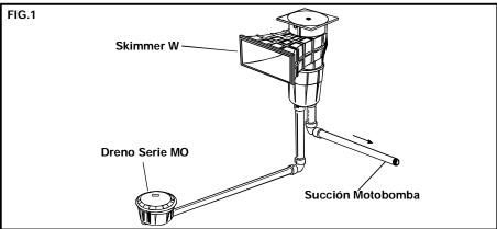
SERIE SV: Skimmer es conectado a la succión de la bomba y si se utiliza dreno de fondo éste también deberá ser conectado a la succión de la bomba (fig.2). No se requiere línea de aspiración de fondo, ya que la manguera del aspirador puede ser conectada al skimmer por medio de la tapa adaptadora del aspirador.
