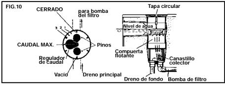
El limitador de la compuerta flotante tiene 2 funciones: impide que movimientos muy violentos del agua hagan golpear la compuerta flotante contra la tapa circular y evita que la compuerta flotante quede inmovilizada cuando el nivel del agua esté por sobre la boca del skimmer. Recuerde efectuar con frecuencia la limpieza del cesto colector para evitar que exceso de suciedad reduzca el caudal por el skimmer y perjudique su funcionamiento.
