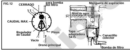
**DRENAJE:** Si fuese necesario vaciar totalmente la piscina con instalación combinada (skimmer, dreno, bomba) proceda como sigue: retire tapa circular, limitador de compuerta, compuerta flotante y cesto colector. Ajuste el regulador de caudal en posición caudal máximo y coloque el cesto colector. Ponga tapón en abertura central de la tapa adaptadora del aspirador y colóquela sobre el
